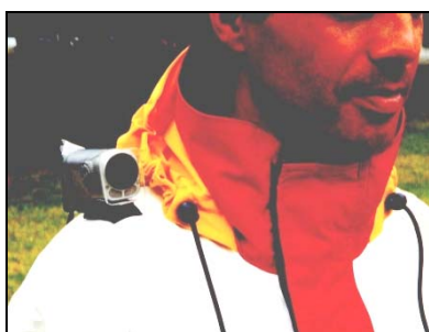
Système de « caméra mains libres » (équipée d'un objectif grand angle), permettant d'enregistrer les comportements et communications verbales des entraîneurs en navigation, au cours des compétitions.
