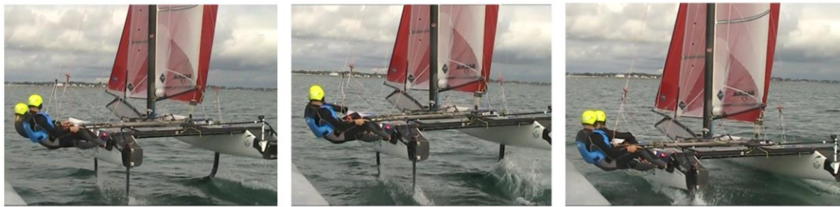
Figure 13. Séquence photographique du décrochage du foil, de gauche à droite : Sur la première photo le foil sous le vent est à fleur d'eau dans le passage d'un clapot transversal. Sur la deuxième photo l'écoulement d'eau autour du foil n'est plus laminaire. Sur la troisième photo le bateau descend et va taper l'eau suite à la perte de portance du foil sous le vent
